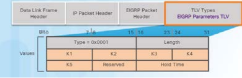
EIGRP TLV: EIGRP Parameters
